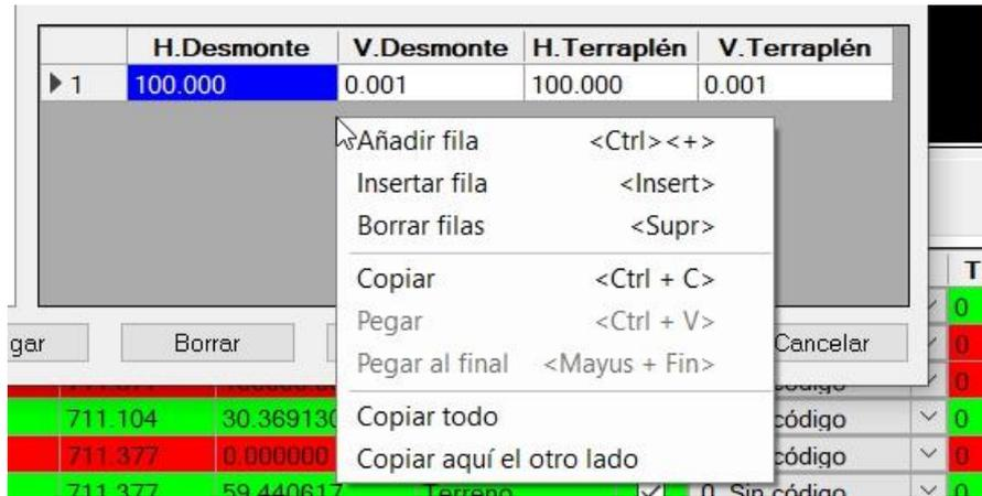
Si agregas más de un vértice el programa supondrá que es un talud con berma y buscará el corte de este talud, en cualquiera de sus tramos, con el “terreno”, (capa a intersectar). Si has puesto que el talud es escalonado y pones dos tramos aquí, el programa repetirá esos dos tramos hasta que encuentre el corte con el “terreno”.
