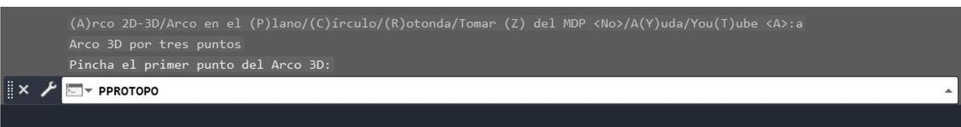
En los tres casos, arco, círculo o rotonda, el programa te muestra las coordenadas de los tres puntos seleccionados para que puedas comprobar que los has seleccionado correctamente. (Recuerda activar la referencia a objetos a "Nodo", "Punto final", etc, para que el programa te tome la zeta).
