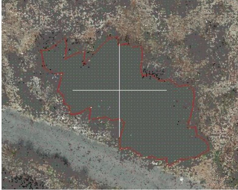
Esta polilínea calculada está en cota 0.000 por lo que se puede hacer un “offset”, “EQDIST”, por si deseamos que esté un poco por fuera del hueco. Este “EqDist” se puede hacer manualmente con la orden “EQDIST” del CAD o también se le puede incluir un retranqueo en la configuración, antes de crear el polígono. Con “EQDIST” de 1m vemos la imagen siguiente:
